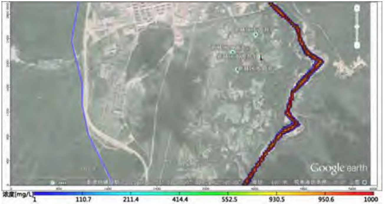
图 14. 4-36(a) 新林区管道原油泄漏到河水后 100 天对周边地下水影响
